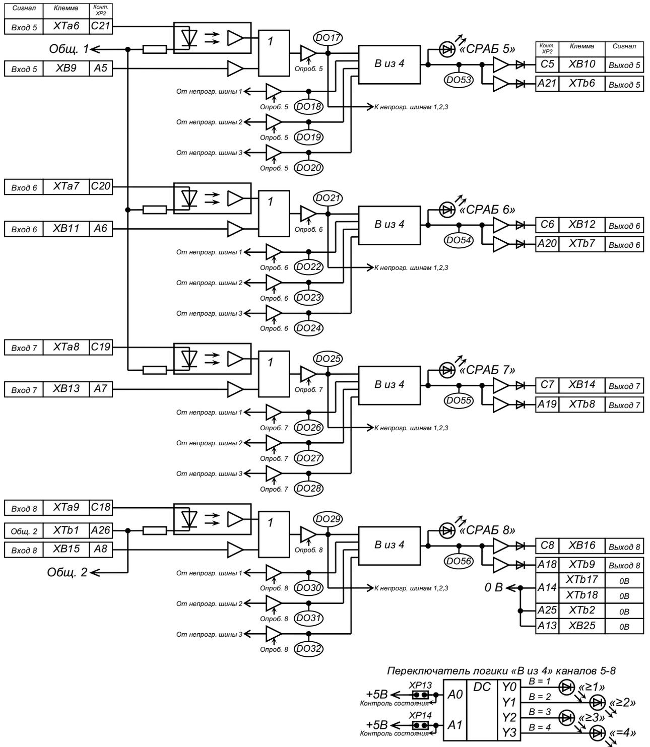
Рисунок 1.2 – Схема электрическая функциональная, часть 2
