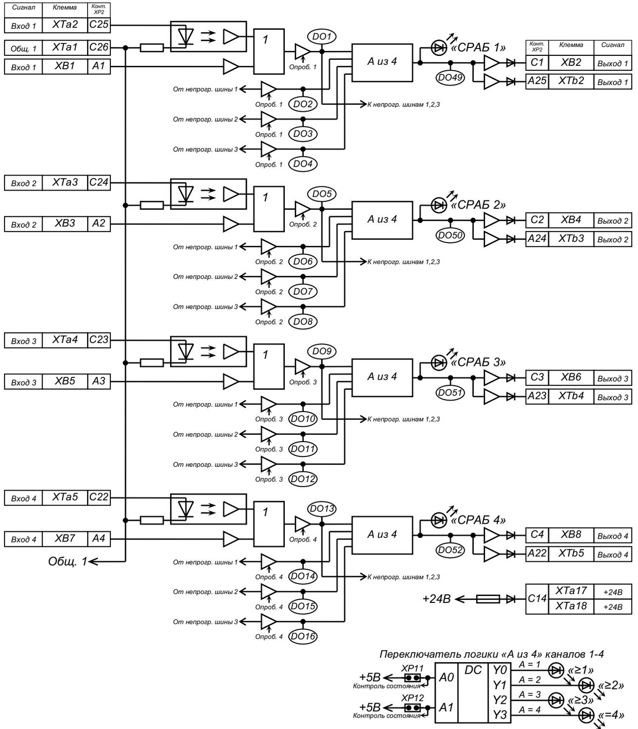
Рисунок 1.1 – Схема электрическая функциональная, часть 1
